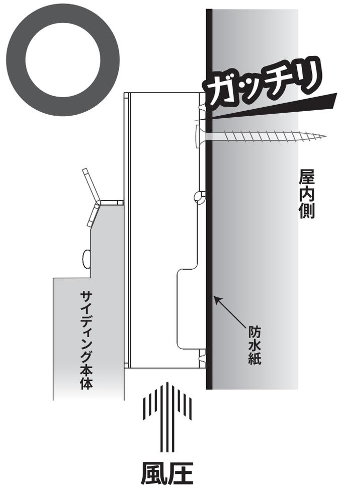
※本製品には釘穴を設けておりません。釘で施工されますと金具とサイディング本体の合いじゃくり部が密接されず金具が動いてしまい、サイディング本体の滑落原因となりますので **絶対に釘を使用しないでください。**
