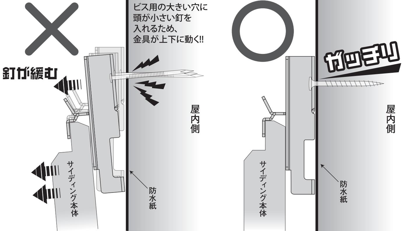
※本製品には釘穴を設けておりません。釘で施工されますと金具とサイディング本体の合いじゃくり部が密接されず金具が動いてしまい、サイディング本体の滑落の原因となりますので、絶対に釘を使用しないでください。
