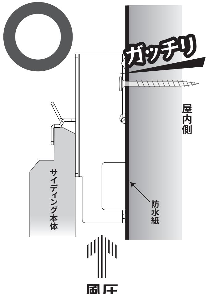
※本製品には釘穴を設けておりません。釘で施工されると金具とサイディング本体の合いじゃくり部が密接されず金具が動いてしまい、サイディング本体の滑落原因となりますので 絶対に釘を使用しないでください。
