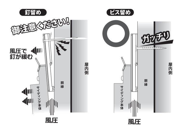
※本製品にはビス穴の他に釘穴も設けておりますが、金具を釘留めする場合、強風時などで内部通気層からの風圧により釘がゆるみ、留付金具にガタツキが生じる場合がございますので、十分な保持力のあるビスをご使用されることをおすすめします。
