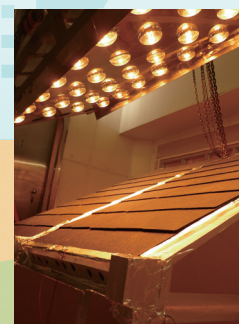
熱貫流試験体
