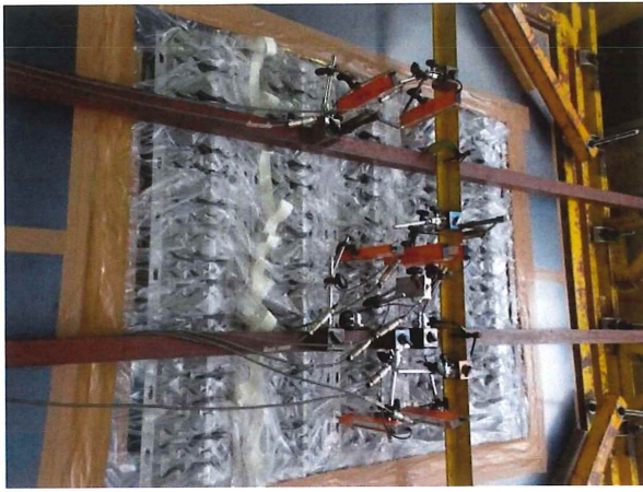
写真7 変位計設置状況 (試験体 No.1 : 屋外側)
