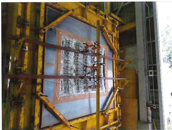
写真 13 試験時の試験体の状況 (+8.00kPa 時：試験体 No.1)
