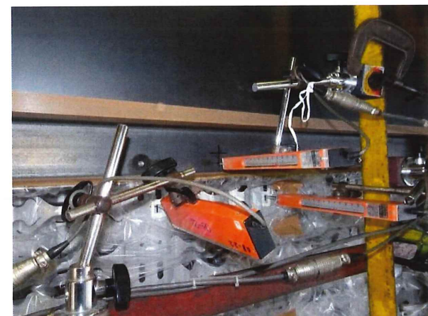
写真12 変位計設置状況 (試験体 No.2 : 屋内側)
