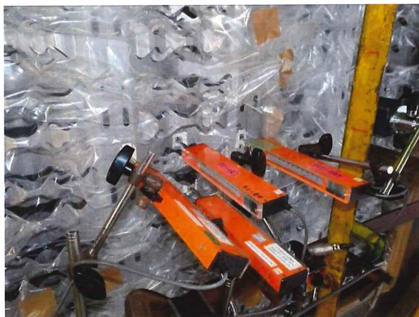
写真11 変位計設置状況 (試験体 No.2 : 屋内側)
