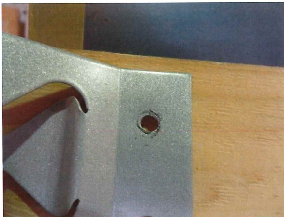
写真 21 試験後のフラクタル固定孔 (屋外側：試験体 No.1)
