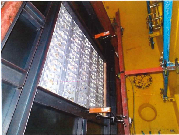
写真9 変位計設置状況 (試験体 No.1 : 屋内側)
