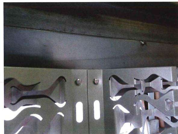
写真 28 試験後のフラクタル固定状況 (屋外側：試験体 No.2)
