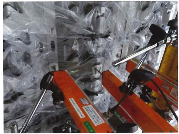
写真8 変位計設置状況 (試験体 No.1 : 屋外側)
